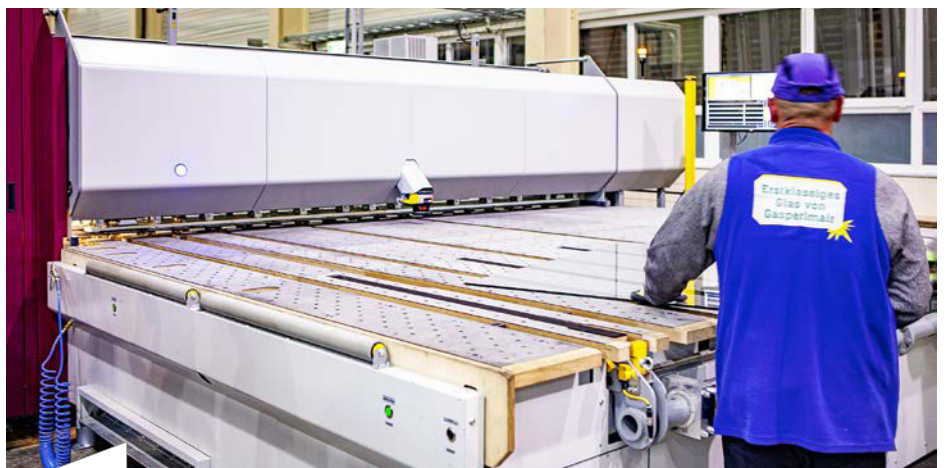
Der Lisec VSL-A kann etwa 30 Prozent mehr Glas pro Stunde schneiden als herkömmlichen Anlagen.
