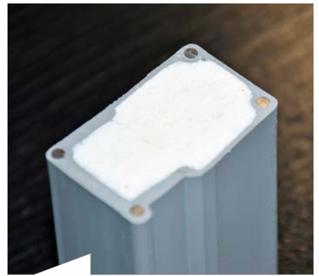
Forthex ist das Verstärkungsprofil für den Blendrahmen. Ein aufgeschäumter PVC-Glasfaser-Kern sorgt für den wärmedämmenden Ansatz.
