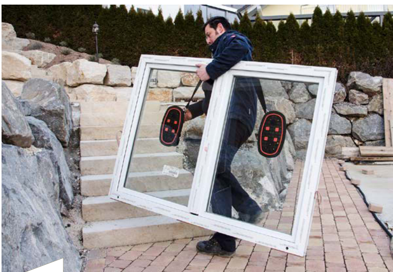
Der Handsauger Nemo dient dazu, flächige Materialien zu heben und zu transportieren. Hierbei spielt es keine Rolle, ob es sich um glatte oder strukturierte Oberflächen handelt.
