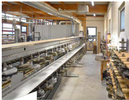
Unter beengten Platzverhältnissen verrichtet in einem Nebengebäude ein Conturex 125 Vario seinen Dienst. Das umfassende Werkzeugmagazin (Aigner) sorgt für geringe Ausfallzeiten.
