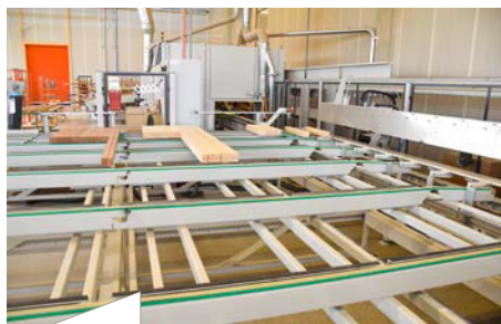
Die Auf- und Abnahme der Werkstücke erfolgt bei dem Conturex an verschiedenen Stellen.
