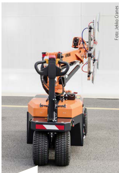
Mit den serienmäßigen geländegängigen, pannensicheren Rädern lässt sich der MPK06 auch auf schwierigem Gelände einsetzen.
