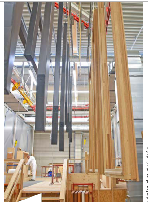
Die Holz Einzel- und Rahmenteile werden auf der Lackieranlage von R+H beschichtet.
