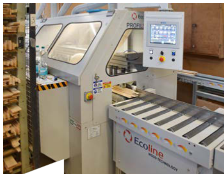
Die Ecoline Profilschleifmaschine wurde eigens für das Unternehmen neu konfiguriert. So lassen sich die Oberflächen der Fensterkanten optimal vorbehandeln.
