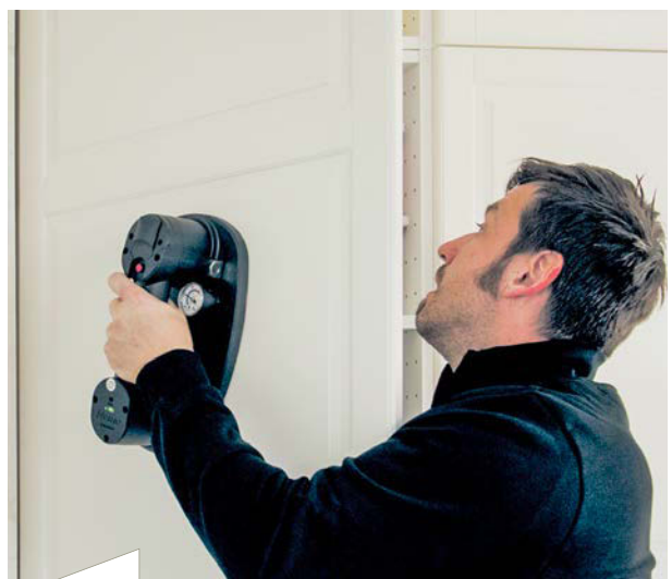
Mit dem elektrischen Vakuumhandsauger Nemo können Gewichte bis zu 170 kg einfach bewegt und sicher platziert werden.
