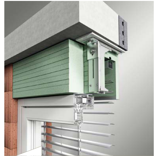
Die Stabilisierungskonsole Stabilium SK HSA trägt auf die Hebeschiebeanlage wirkende Wind- und Stoßlasten in das darüberliegende Mauerwerk ab.
