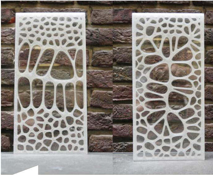
05: Hier im Bild zwei Verbundglaselemente mit unterschiedlichen Kunststoffkernen im Voronoi-Muster. [3]
