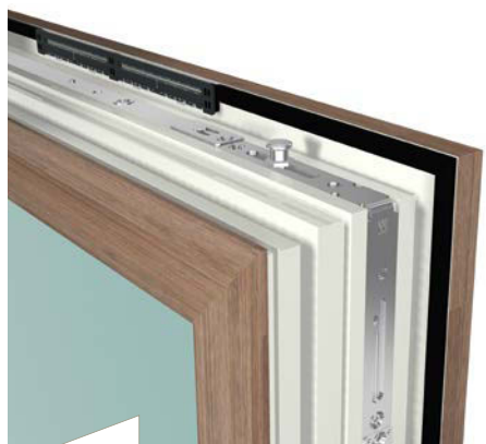
Caire flex ist die Lösung zur passiven Basislüftung: Der Fensterfalzflüster bringt schon bei geringen Luftdruckunterschieden Frischluft in die Wohnräume, bietet also insbesondere eine wirksame Schimmelprophylaxe
