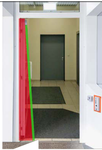
Dargestellt sind hier die Risiko-Zonen, wenn die Tür nur auf der Gegenbandseite sensorisch gesichert ist.
