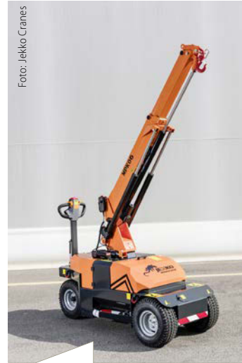
Der Elektro-Fahrkran arbeitet serienmäßig sowohl mit Haken (o.) als auch mit Manipulator (linkes Bild).
