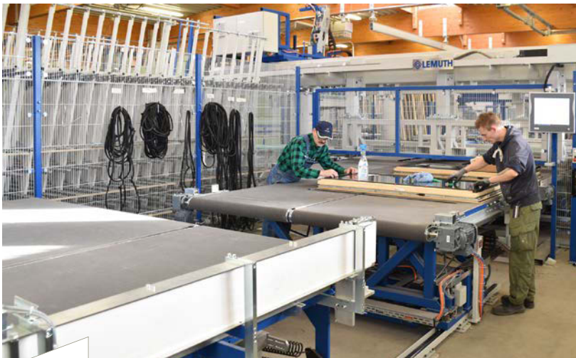
Nach der Klebestation werden die Flügel an drei Montagetischen weiterbearbeitet und in die Flügelpuffer übergeben.
