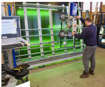
Eingangskontrolle der Isolierglaseinheiten: Hier werden die Gläser auf Fehler kontrolliert und anschließend in das Glaslager aufgenommen.
