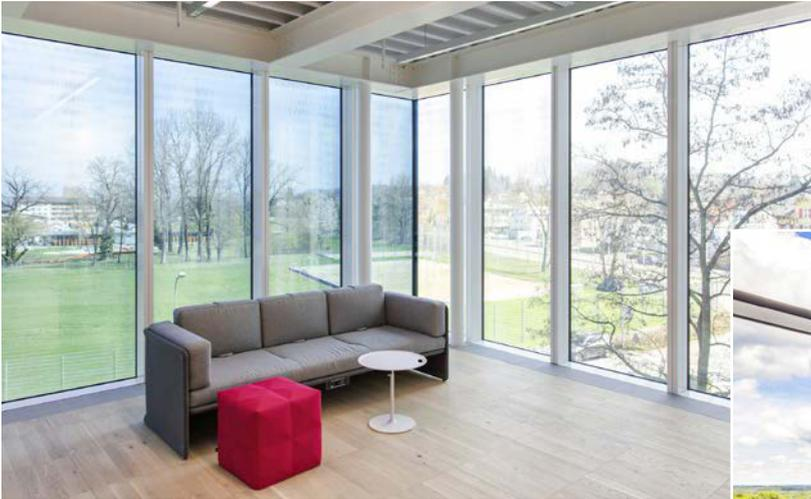
**SageGlass:** Die Fassade dieses Gebäudes in der Schweiz ist mit schaltbarem SageGlass ausgestattet; so konnte auf außen liegenden Sonnenschutz verzichtet werden.
