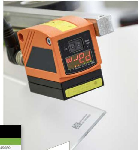
Mit der Lasermarkierung lässt sich das Glas im kompletten Produktionslauf tracken.
