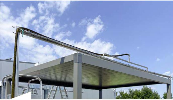
**Der Wassertest wurde nach den Vorgaben der DIN EN 1933 durchgeführt. Aufbau, Durchmesser und Abstand der Düsen werden hier genau vorgegeben.**
