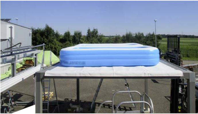
Wenn man keinen Schnee hat, nimmt man Wasser. Die erforderliche Prüfung konnte so genau über den Füllstand der Wasserbecken definiert werden.
