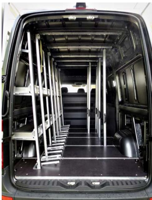
Innenreff mit zweiseitig klappbarer Auflage, Wann für Material. Lochraster und Spannstangen erlauben es, gleichzeitig Fenster und Glas auf mehreren Ladepositionen zu transportieren.
