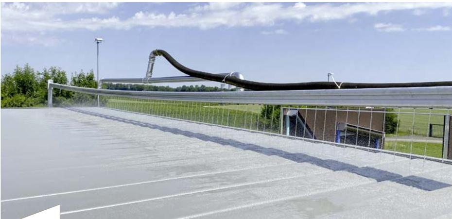
Um die Wasserdichtigkeit von Lamellendächern und den Wasserabfluss zu prüfen heißt es schon einmal „Wassermarsch“ bei den Herstellern. Geprüft wird min. mit 56 ltr/h m<sup>2</sup>, was einem schweren Landregen (Klasse 2) entspricht.
