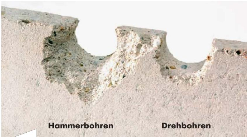
Das Beispiel zeigt deutlich die Auswirkungen des falschen Bohrverfahrens, wenn es z. B. um die Bohrlochgeometrie in Kalksandsteinen geht. Die Lehre daraus: Hammerbohren ist tödlich für dem Stein.
