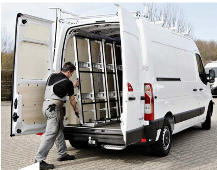
**Bedienerfreundlich:** Das ausziehbare Innenreiff ermöglicht das Aufstellen des Glases auf Körperhöhe, gleichzeitig werden hochwertige Güter beim Transport im Innenraum optimal vor Witterungseinflüssen geschützt.
