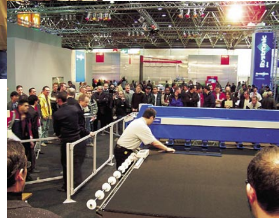
Gutes Preis-Leistungsverhältnis: der halbautomatische Schneid-tisch für VSG „Smart'lamicut“
