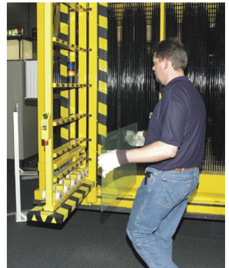
Wie von Geisterhand gesteuert fährt die Einschubhilfe das richtige Fach an – einfach und ergonomisch stellt der Bediener die Scheibe ein und quittiert den Vorgang
