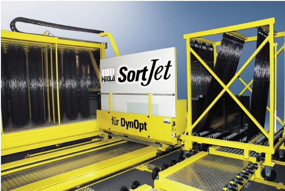
Wie ein Jetstream zieht der „SortJet“ die im dynamischen Puffer gespeicherten Zuschnitte heraus und verdichtet diese jeweils auf einem Fächerwagen
