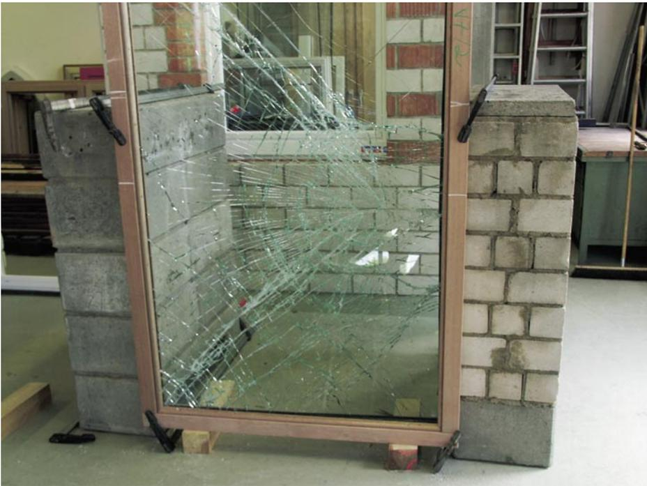
Eine Beschädigung ohne Freigabe der Öffnung ist für das Bestehen der Prüfung nicht schädlich
