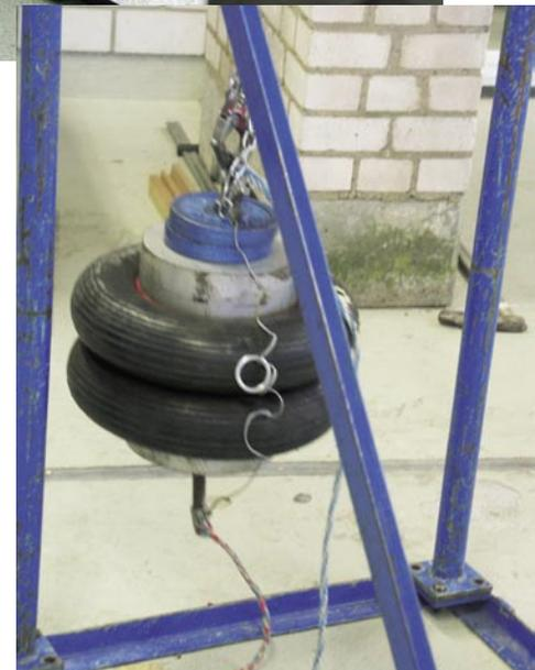
So sieht der 50 kg schwere Pendelkörper mit den Zwillingsschleifen aus
