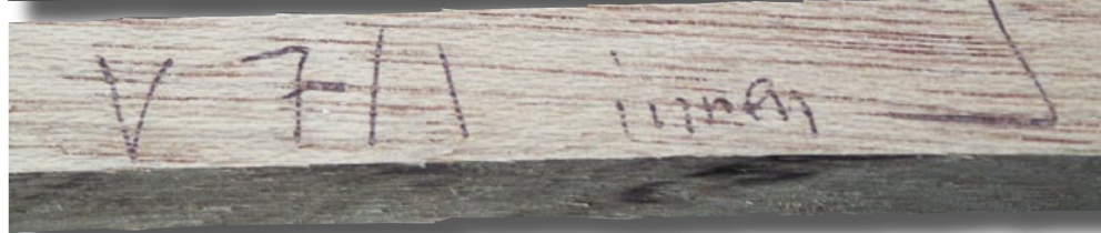
Zur Ermittlung der tatsächlichen Rohdichte wurden Streifen aus den einzelnen Lamellen der Rahmen herausgeschnitten
