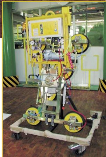
Die Tragfähigkeit eines Gerätes ist bei Einkreis-Systemen nicht mehr gewährleistet, wenn Sauger oder Schlauch undicht sind – ein Lastabsturz ist die Folge
