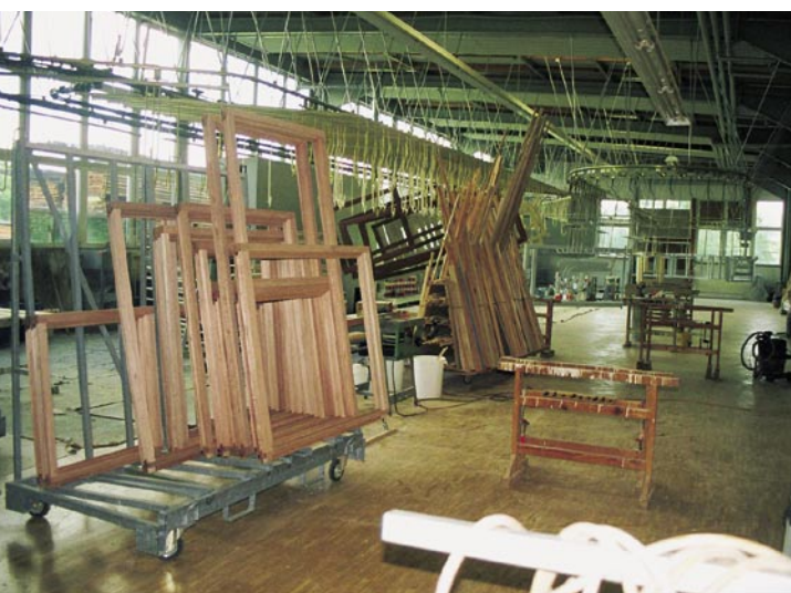
Blick in die rationelle Bearbeitung zugelieferter Kanteln und Rohlinge für Fenster und Türen
