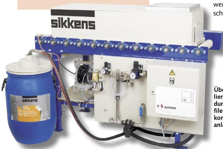
Über den stufenlos regulierbaren Rollentransport durchlaufen die Fensterprofile die von Range + Heine konstruierte Durchlaufflutanlage
