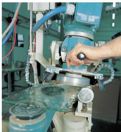
Bild oben: Beim Facettenschliff werden die Glaskanten schräg abgeflacht
