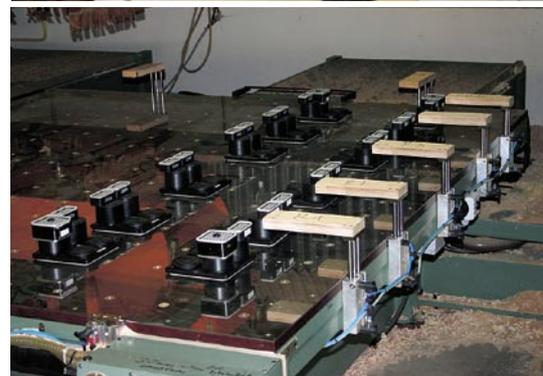
Bild oben: Eine Auswahl von Innospann-Modulen für den flexiblen Aufbau und die schnelle Umrüstung von Vakuum-Spannvorrichtungen für verschiedene Holzteile
