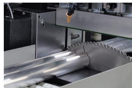
Das Sägeblatt mit 500 mm Durchmesser schneidet gleichzeitig mehrere nebeneinander gespannte Profilstäbe
