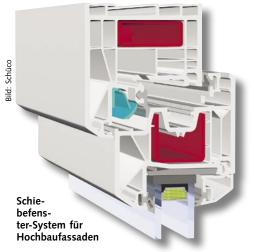
S 70HPS.HI" ist auch in zweifarbiger Ausführung erhältlich. Innen- und Außenschale können mit allen verfügbaren Farben und Oberflächen separat beschichtet werden. Ein Ausklinken der Profile ist nicht erforderlich. Der Blendrahmen wird stumpf gestoßen, der Flügelrahmen umlaufend auf Gehrung geschnitten.
