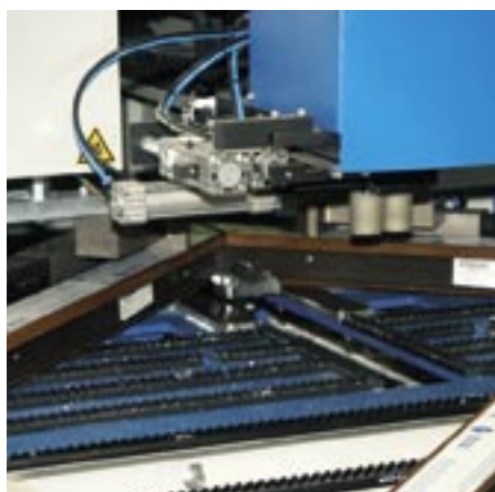
Die qualitativ hochwertige Bearbeitung durch die Schneid- und Fräswerkzeuge der horizontalen Einkopf-Verputzmaschine hat bei Drinkuth überzeugt; mittlerweile werden hier ebenfalls alle Designflügelelemente aus dem Fensterbereich gefahren
