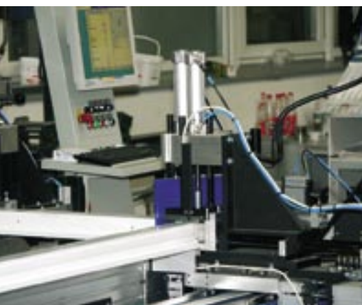
Nach dem Einlegen der Profile in die horizontale Schweißmaschine und dem vorherigen Einlesen der Einzelprofile über den Barcodescanner, laufen alle anderen Arbeiten vollautomatisch ab – im Bild der Schweißvorgang im Detail
