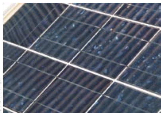
Einzelne Silizium-Solarzellen werden zu Modulen zusammengefasst
