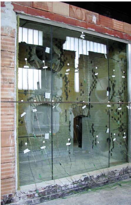
Das EI 60 Element mit eingelassenen oberen und unteren Metallprofilen; die linke schmale Scheibe ist am Wandanschluss nicht befestigt
