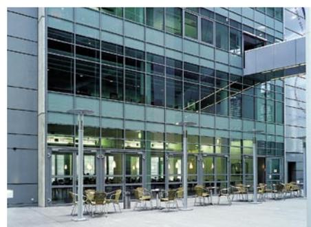
Normalfassade, Brandschutzfassade sowie Brandschutztüren in einer optisch identischen Konstruktion
