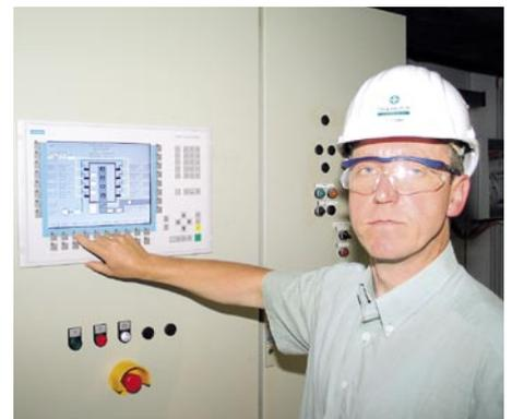
Kontrollwarte der neuen Brandschutzprüfungsanlage von Pilkington: Anlagen- und Prüfdaten des Glases bzw. der Konstruktion werden über den gesamten Prüfzeitraum hinweg elektronisch erfasst und können in Verbindung mit Videoaufnahmen der Prüfung detailliert ausgewertet werden
