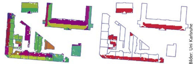
Links: Extrahierte ebene Dachflächen aus flugzeuggetragenen Laserscanningdaten (Ausschnitt Testgebiet Karlsruhe) rechts: Selektion der für Photovoltaik geeigneten Dachflächen aufgrund der Parameter Mindestgröße, Neigung und Exposition (Gebäudekonturen blau – Ausschnitt Testgebiet Karlsruhe)
