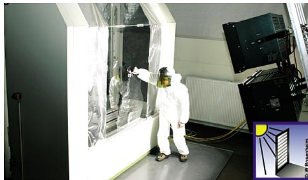
Prüfung komplexer innovativer Bauteile mit kalorimetrischen Messverfahren
