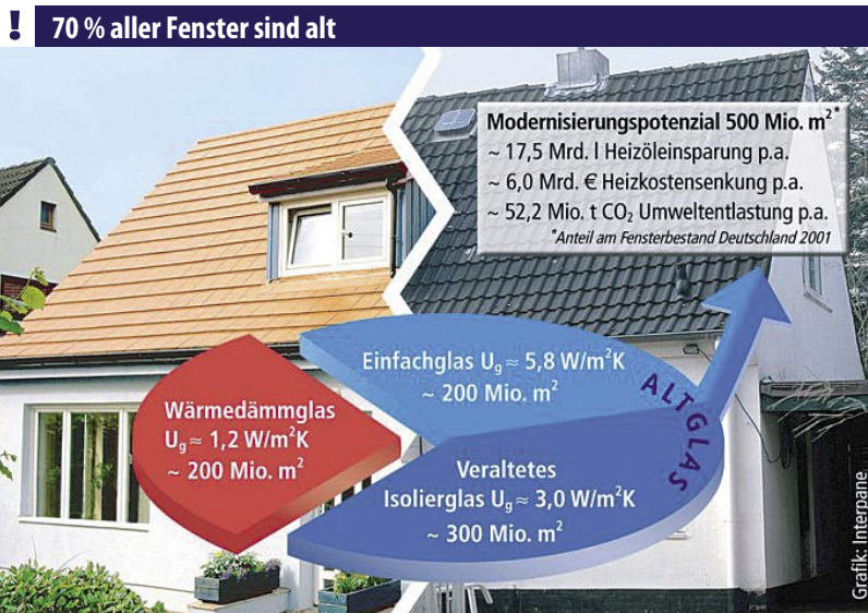
Modernisierungspotenzial im Fensterbestand
