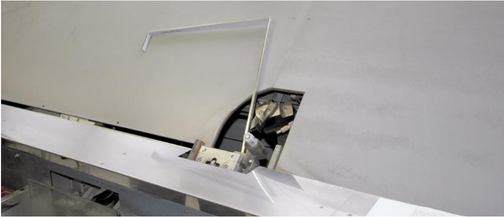
Der Abstandhalter „Trösch ACS Plus“ in einem Lisec-Bieger im Werk Glas Trösch Isolierglas in Altshausen
