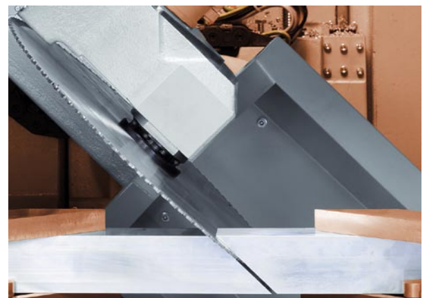
Die Säge kann je nach Neigungs- oder Schwenkwinkel nahe am Spanner positioniert werden
