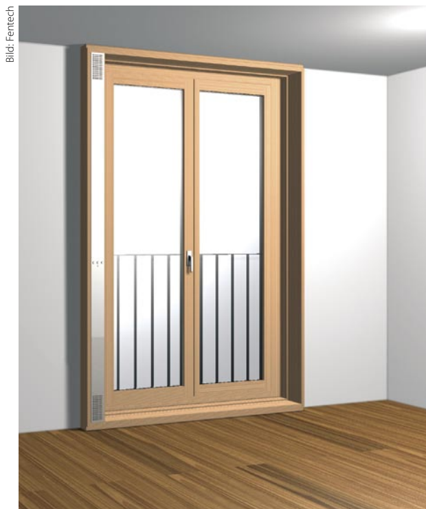
Holzfenster mit Frischluftversorgung und Wärmerückgewinnung
