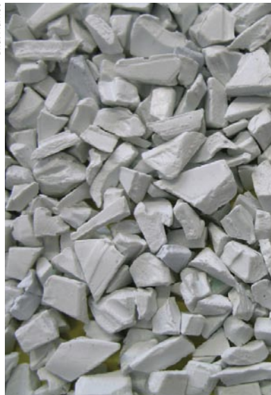
Sauberes PVC-Mahlgut zur Produktion von neuen Fensterprofilen
