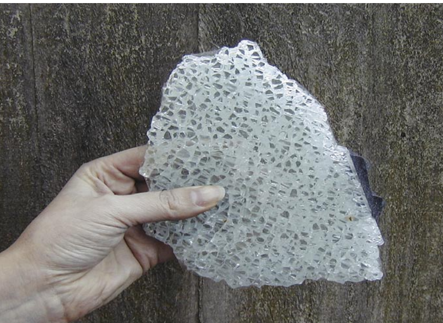
Typische Krümelschollen: Teilfläche eines Glasbruchs
