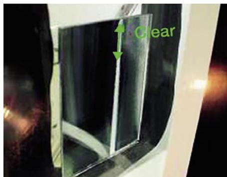
Bild 4: Kondensation an der Scheibeninnenseite; der grüne Pfeil zeigt den klaren Bereich
