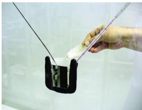
Bild 3: Taupunktmesseinrichtung mit Aceton gefülltem Plastikbecher bei der Trockeneiszugabe
