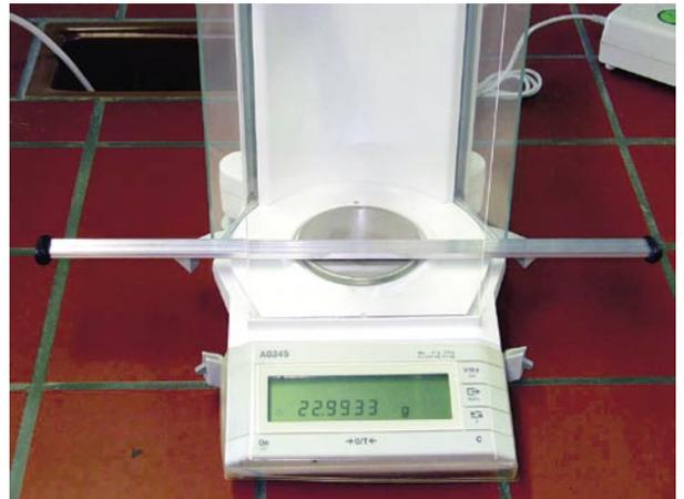
Bild 2: Abstandhalter auf der Waage
