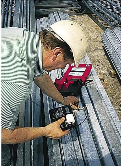
Bild 1: Magnetinduktive Schichtdickenmessung
