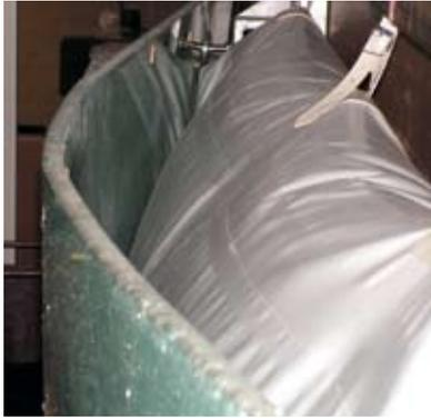
Statische Simulation von hohen Windsoglasten im Labor
