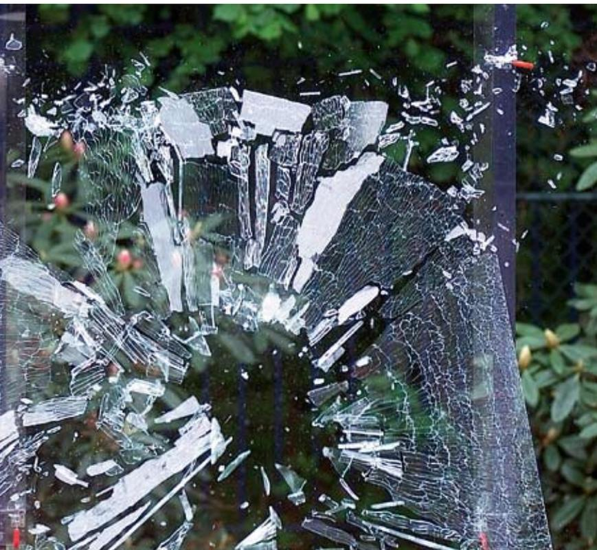
*Glasbruch bei einem ESG Glas durch externe Beschädigung*
