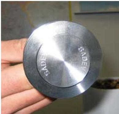
Durch das Einbringen von Tellermanschetten bei Senkkopfhaltern, wurde die Resttragfähigkeit unter Windbelastungen deutlich erhöht
