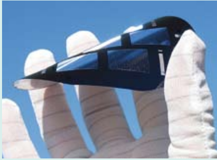
80 µm dünner Wafer mit Testsolarzellen
