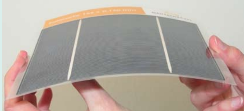
Industriell gefertigte 150 µm Solarzelle
