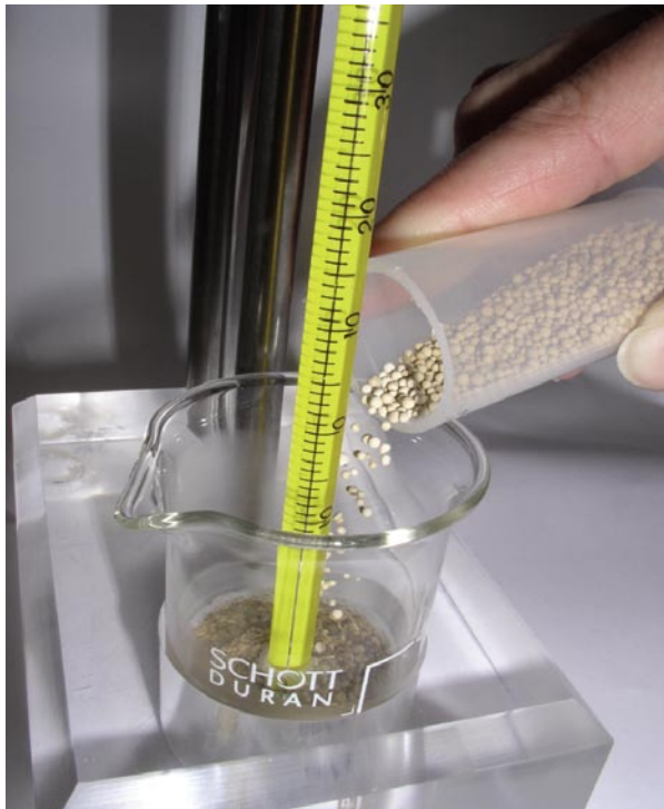
Bild 1: Der Delta-T-Messaufbau nach Grace Methode
