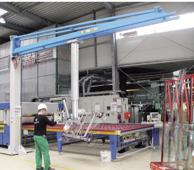
Der Vakuumheber „Easy-Lift“ im Einsatz vor der ESG-Produktionslinie
