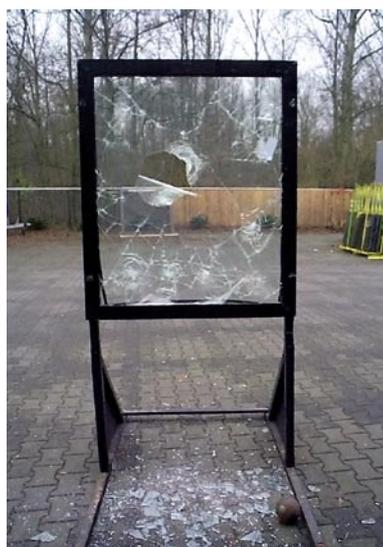
Splitterschutzfolie im Test
