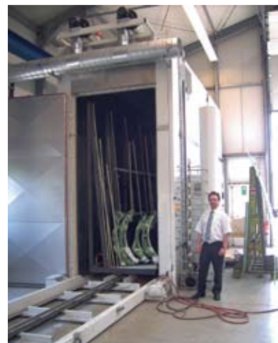
Nur noch wenige Handgriffe fehlen, bis der neue Heat-Soak-Ofen bei Finiglas einsatzbereit ist
