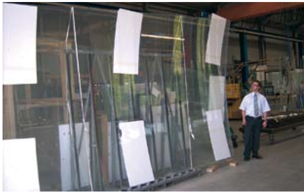
Großformatige gebogene Scheiben im Finiglaswerk in Düren
