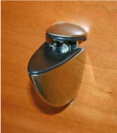
Ansicht des aufgebogenen oberen Klemmwinkels des Glashalters der zerbrochenen Regalscheibe
