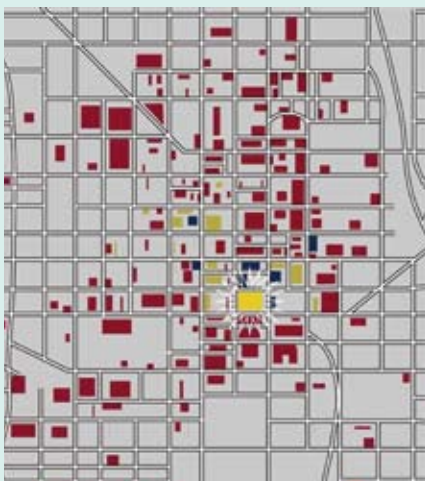
Der Bombenanschlag auf das Murrah Federal Building in Oklahoma/USA verursachte im weiteren Umkreis (bis zu 1,2 km) den gefährlichen Splitterflug – im Bild links an den rot gekennzeichneten Gebäude zu erkennen
