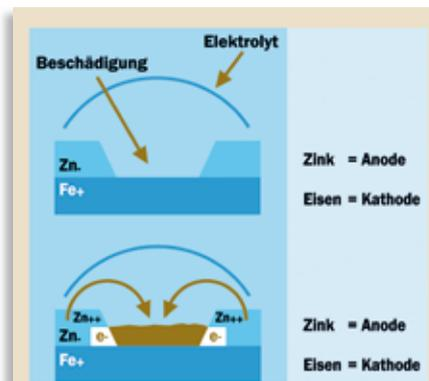
Zinkverbindungen verhindern die Korrosion an beschädigten Stellen des Überzuges
