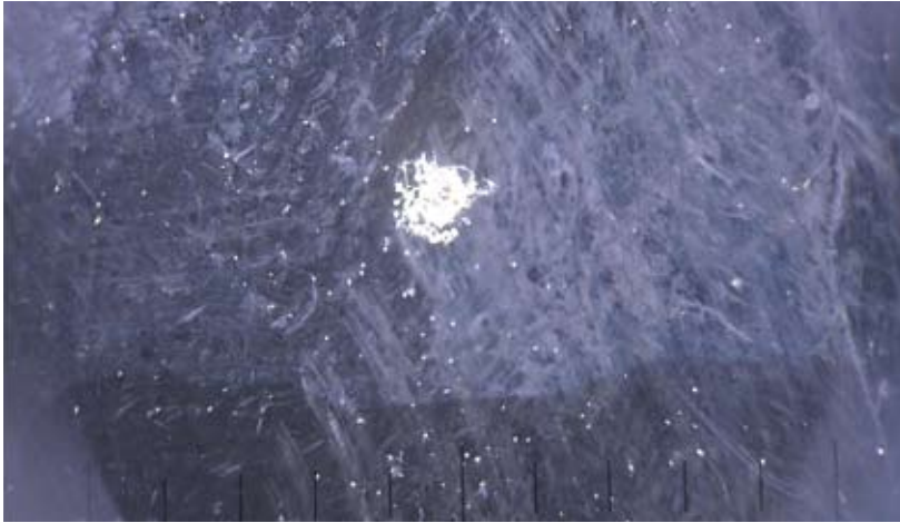
Detailaufnahme mit dem Dermaphot-Aufsatz: Oberflächenzerstörungen durch harte, auf die Glasoberfläche geschleuderte Partikel
