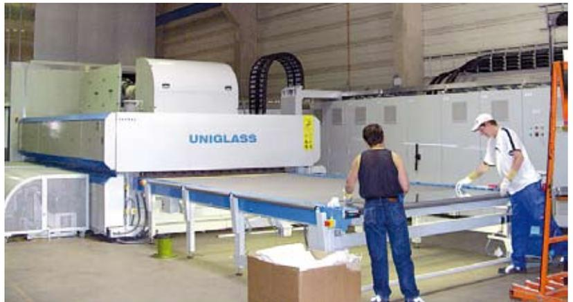
*Die Kapazität des neuen Ofens liegt bei rund 300 000 q<sup>2</sup> ESG pro Jahr, die Scheibengröße beträgt maximal 2 400 mm x 4 200 mm*
