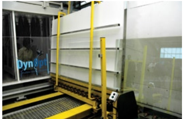
Direkte Übergabe der aus transportierten Scheibe an die Isolierglas-Linie
