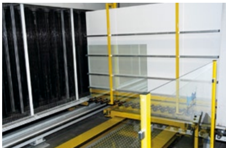
Das Entnahmeschuttelle transportiert nach der von „DynOpt“ vorgegebenen Logik die Scheiben in der verlangten Sequenz aus dem Puffer und übergibt sie direkt an die Isolierglasslinie: Eine weltweit einmalige Lösung
