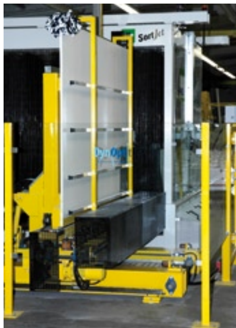
Eintransport einer soeben gebrochenen und aufgerichteten Scheibe in den Dynamischen Puffer
