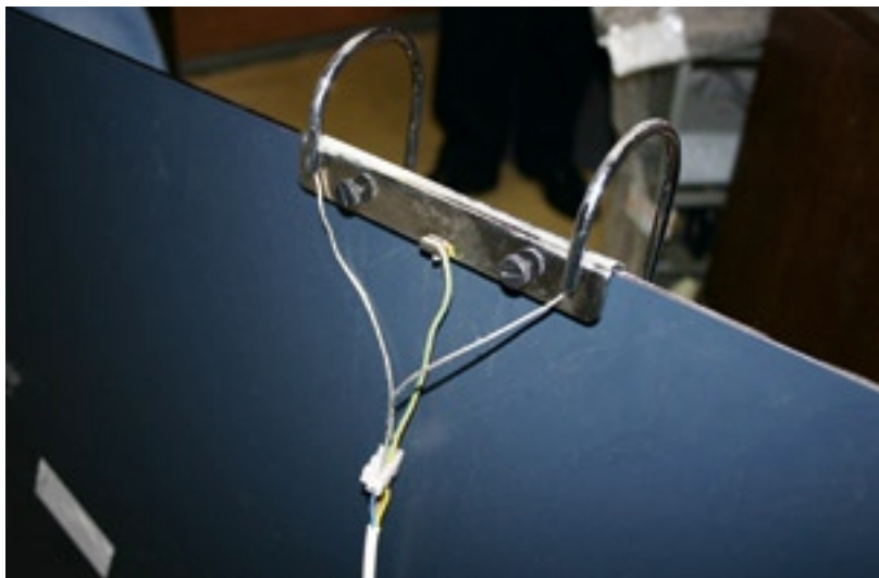
Bild 2: Rückansicht der im Bereich des Risses auf die Oberkante des Spiegels aufgesteckten Lampe
