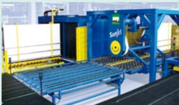
Sortierverdichter „SortJet“ mit Direktanbindung an eine bestehende Schneidlinie
