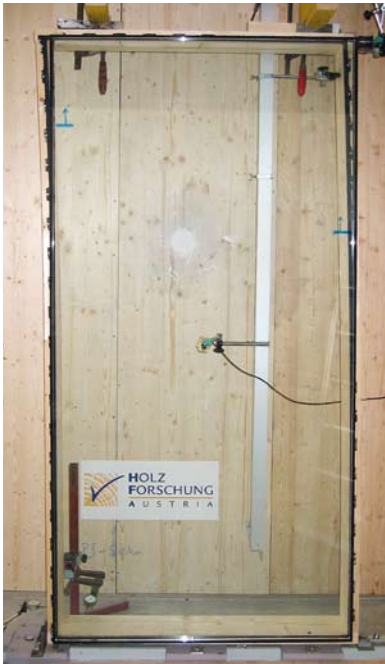
Prüfung der Prototypen: Glas steift aus – Elementversagen bei mehr als zwei Tonnen simulierter Windlast. Die Kraft wurde in Achsrichtung der Kopfschwelle eingeleitet (im Bild rechts oben)
