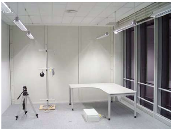
Bild 3: Büroähnlich ausgestatteter Versuchsraum mit hochverglaster Westfassade, innenliegendem Sonnenschutz und abgependelter künstlicher Beleuchtung
