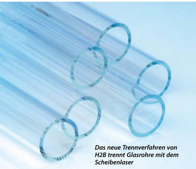
Das neue Trennverfahren von H2B trennt Glasrohre mit dem Scheibenlaser
