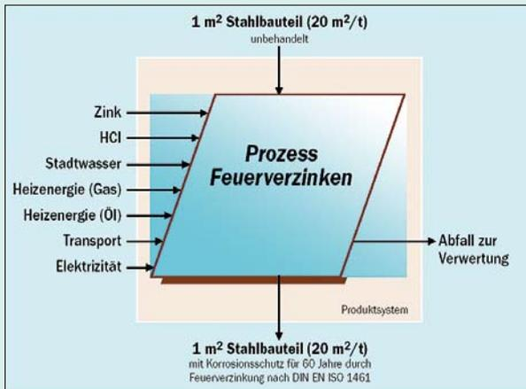
Bild 1: Das Produktsystem Feuerverzinken
