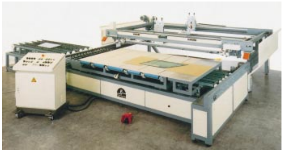
Siebdruckmaschine Typ „SH“ mit Anlegemasken für Formscheiben
