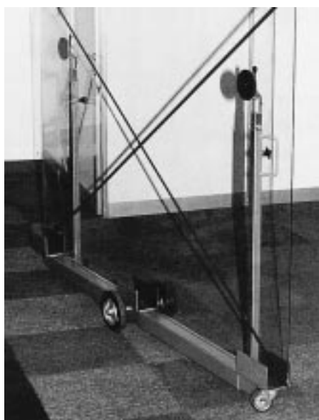
Roller für Scheiben und Fensterrahmen mit dem Vorteil, sich im Drehpunkt schwenken zu lassen
