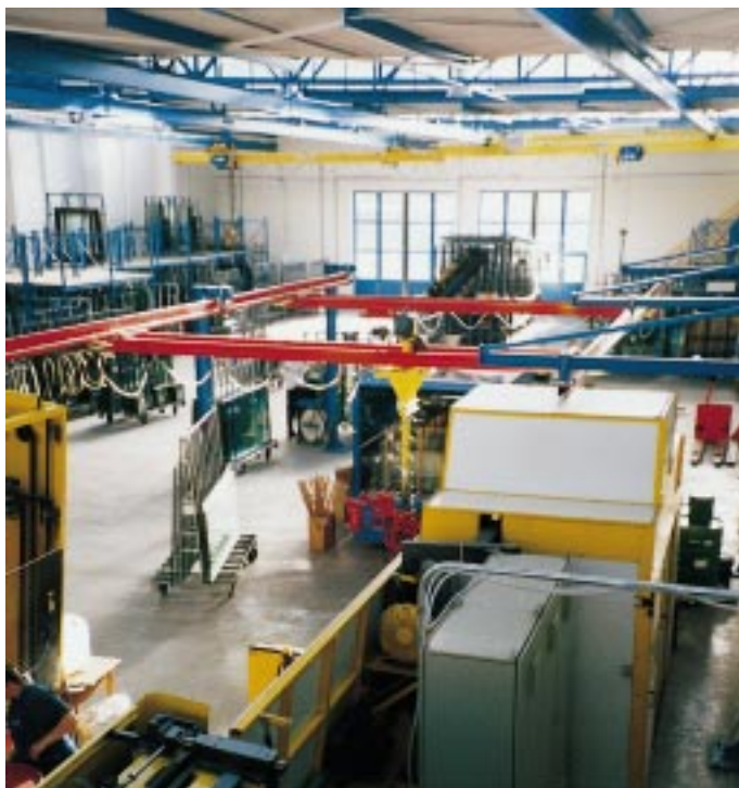
Zwei moderne Uniglas-Isolierglaslinien stehen in Neu-Ulm für die Fertigung von täglich 900 m 2 Funktions-Isolierglas zur Verfügung
