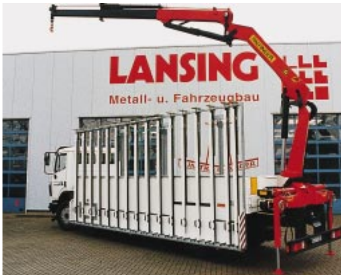
Lkw-Pritsche mit Schwenkreff und Ladekran Fotos: Lansing
