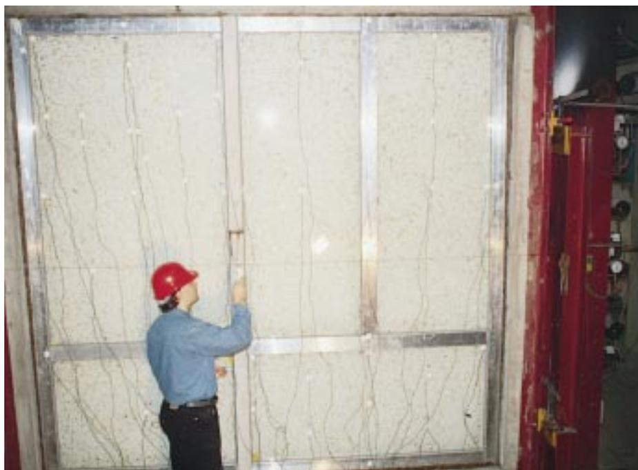
Bei über 1000 °C Ofenraumtemperatur ist an dem Brandschutzglas „Fewadur F90“ auch nach 90 Minuten Prüfdauer keine erkennbare Veränderung festzustellen. Und die Hitzestrahlung in unmittelbarer Nähe der Verglasung ist ungefährlich
